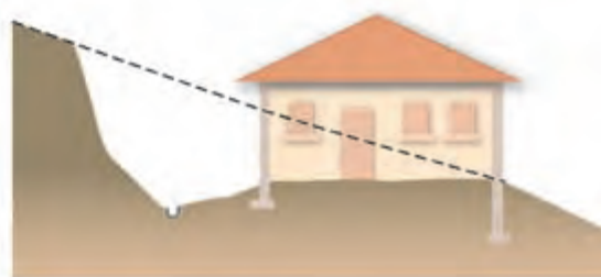
Plate-forme en déblais
